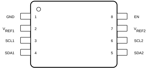
图 5-1. DCU 封装，8 引脚 VSSOP，顶视图
