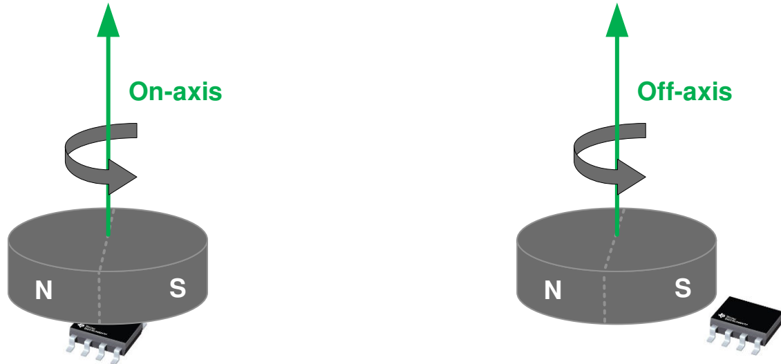
图 8-5. 同轴角度测量与离轴角度测量
