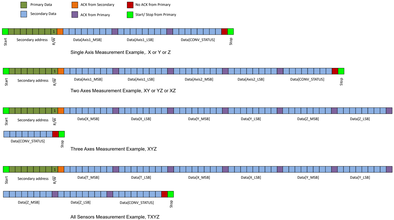
图 7-11. CRC 禁用且 CRC_EN = 0b 时 16 位数据的 1 字节 I 2 C 读取命令
